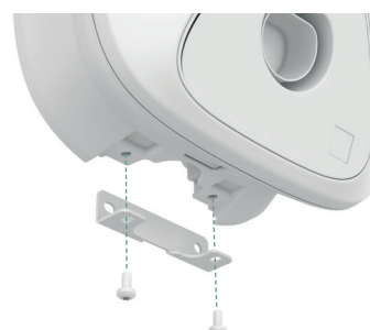
Abb. 17 Befestigen der Unterseite der Ladestation
