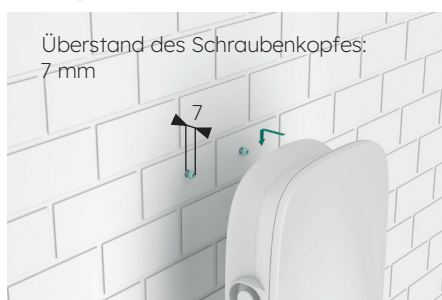
Abb. 16 Einhängen der Ladestation
