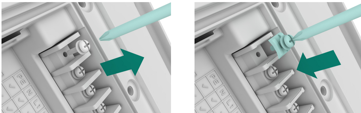
Figura 9 Installazione del morsetto a vite
