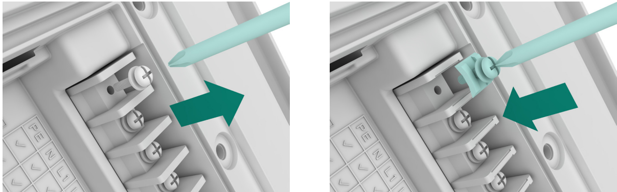
Figure 9. Installation de la vis de fixation
