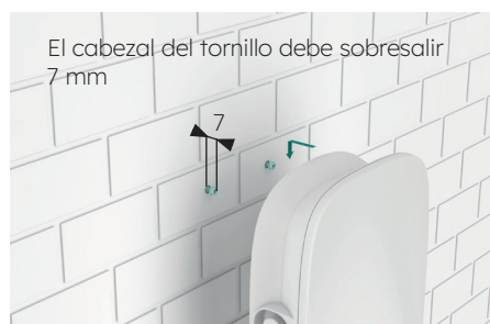
Figura 16 Colgando la estación de carga
